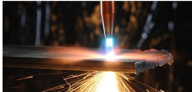
Гасното сечење со оксиген се врши на CNC машина или на оптика со шаблон до дебелина на лимот од 100 mm. Сечењето се врши со плазма до 5mm.
